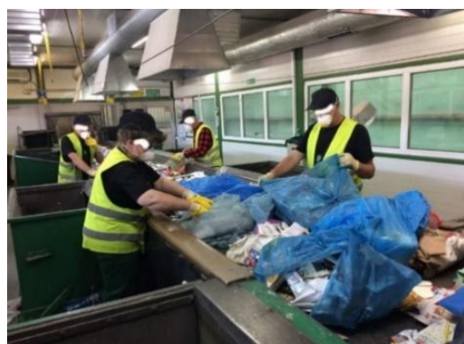
Fot. 2 Linia sortownicza doczyszczania selektywnej zbiórki odpadów
